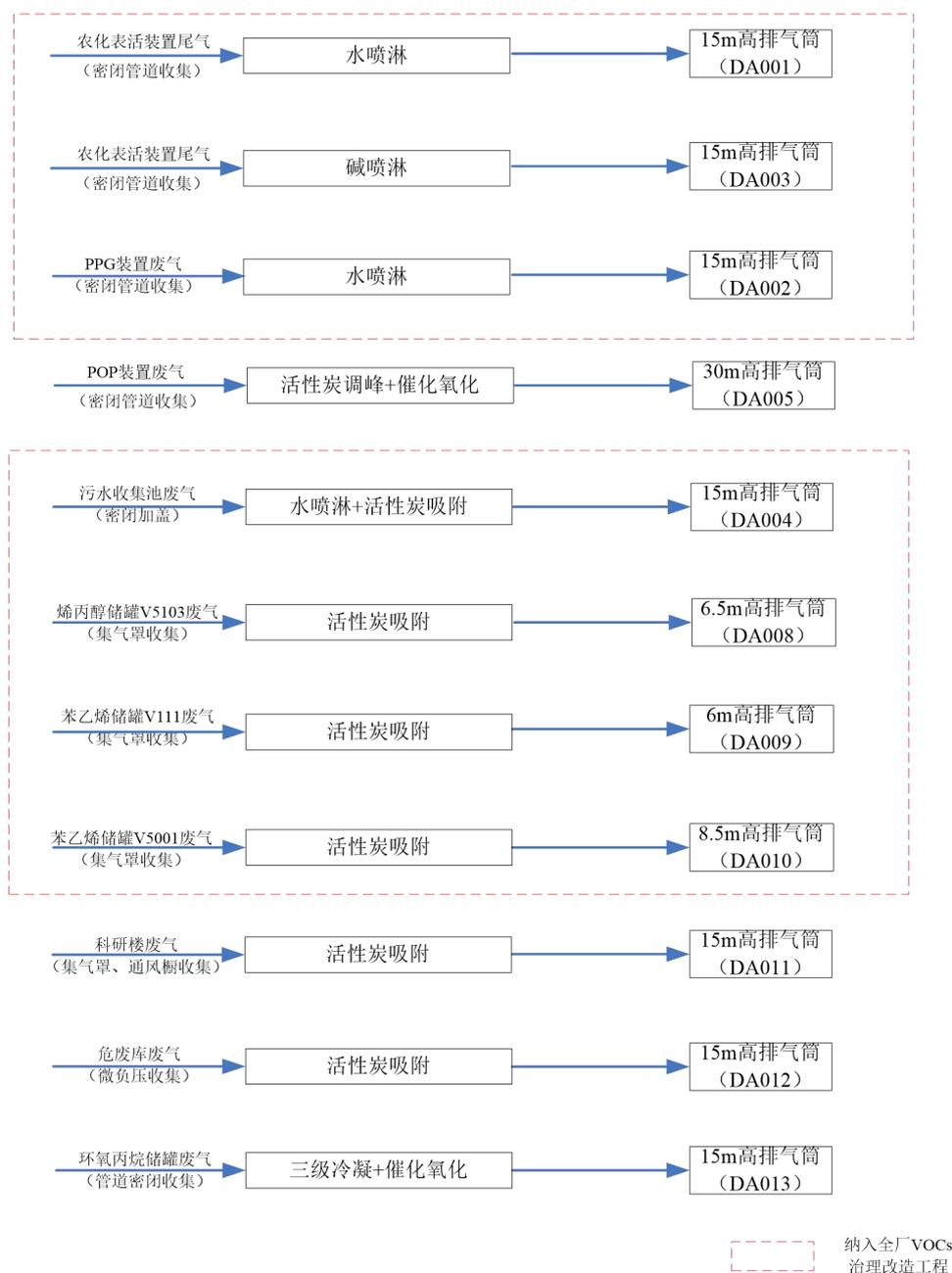
图 4.1-7 现有项目有组织废气处理流程图
