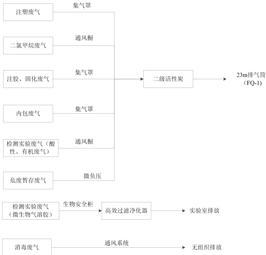
图 4-1 本项目主要废气收集和处理措施流程示意图
