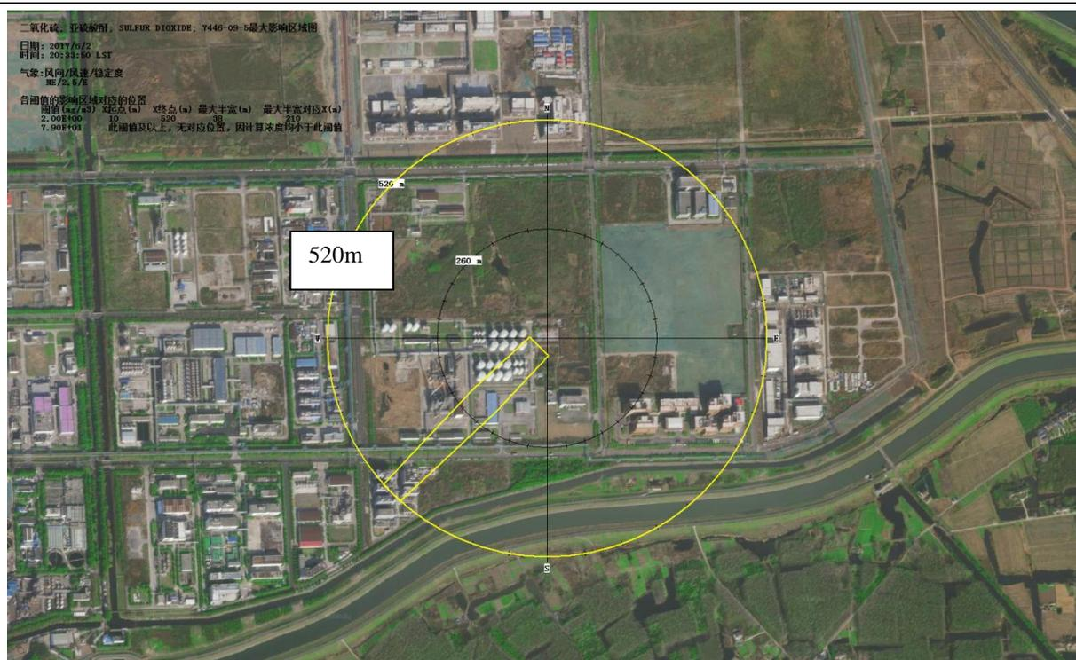
图 6.7-8 最常见气象条件下烷基苯磺酸泄漏火灾伴生/次生  $\text{SO}_2$  扩散影响示意图
