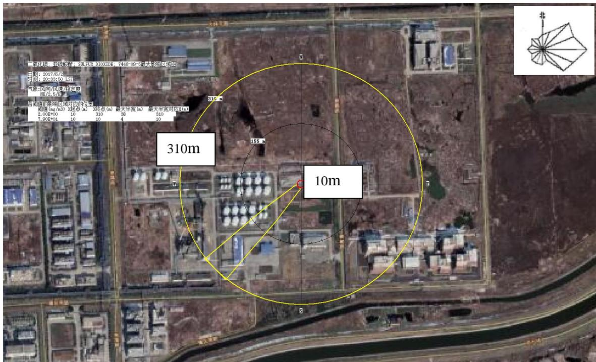
图 6.7-2 最常见气象条件下磺化装置燃硫炉发生泄漏 SO<sub>2</sub> 扩散影响示意图
