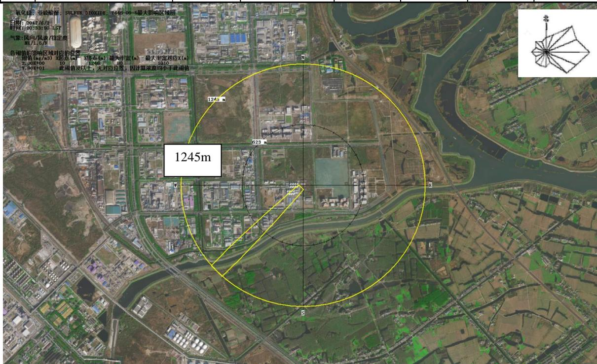
图 6.7-7 最不利气象条件下烷基苯磺酸泄漏火灾伴生/次生 SO<sub>2</sub> 扩散影响示意图
