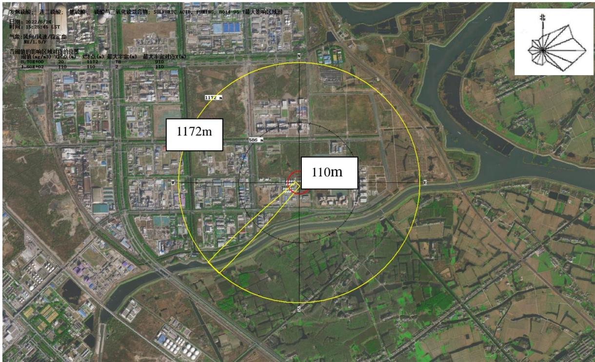
图 6.7-3 最不利气象条件下磺化装置转化炉发生泄漏 SO<sub>3</sub> 扩散影响示意图
